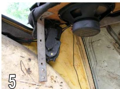
← ❺ Boulonner deux fers plats coudés sur chaque intérieur d'aile arrière. Visser dessus une plaque de contreplaqué assez épaisse pour recouvrir l'espace entre la banquette arrière, la charnière de porte de malle et les vitres de custodes.
