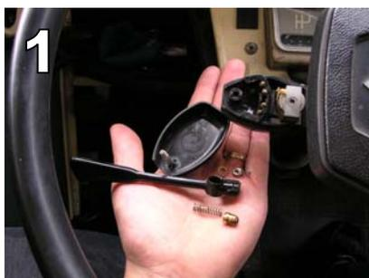
← ❶ Sous le boîtier du commodo se trouve un petit écrou qu'il faut démonter pour accéder au ressort. Attention de ne rien perdre. Enlever 2 ou 3 spires du ressort en fonction de sa résistance. Le bras est plus facile à actionner.
