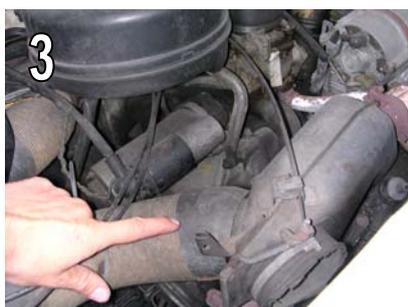
← ❸ La chaleur dégagée par les boîtes de chauffage ayant tendance à s'échapper prématurément dans le compartiment moteur, découper des cylindres de 20 cm de long dans une chambre à air de 2 CV pour relier les manchons à leurs supports.
