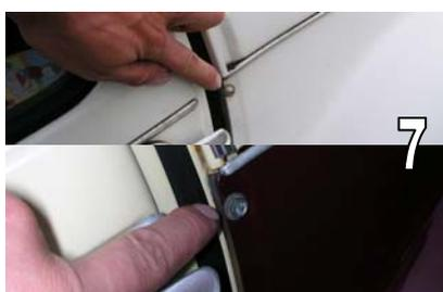
← ❼ Les vis à tête fendue montée d'origine sur les ailes arrière des 2 CV résistent mal au tournevis après des années d'immobilité. Profitez d'un remplacement d'aile arrière ou d'un démontage pour peinture pour les remplacer par des modèles à tête boulonnée qui seront bien plus pratiques et résistantes.
