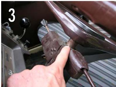
← ❸ Quelques gouttes de liquide de frein serviront à supprimer le grincement de la colonne de direction. Procédez juste derrière le volant à l'aide d'une queue de cuiller à défaut d'une burette en le faisant tourner pour répartir le liquide.
