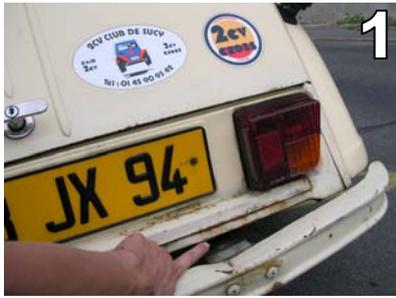
← ❶ C'est avec un compresseur que la vaporisation du mélange 50% gasoil et huile sera la plus efficace. Chaque bout de longeron offre une facilité d'accès aux bords intérieurs du châssis, pare-choc démonté. Arrêter lorsqu'une brume sort à l'opposé, faire l'autre.
