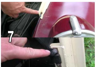
← ❼ Une vis de joue d'aile perdue empêche son remontage, les frottements et la prise au vent faisant leur office. Des vis similaires se trouvent en bas du pied milieu de la coque, sur des habillages de ceintures. En attendant, rangez précieusement les pièces démontées.
